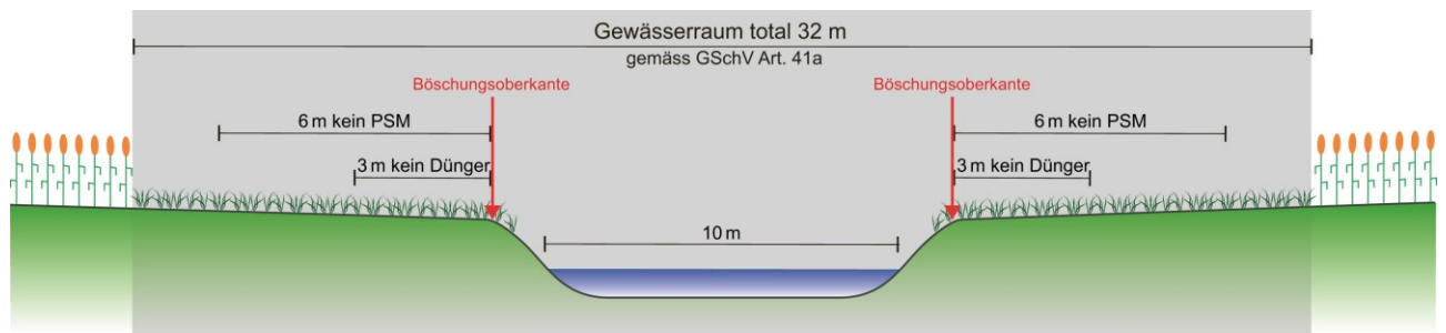
Abb. 2a: Messweise vor der Ausscheidung des Gewässerraums: Messung ab Böschungsoberkante
